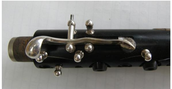
B-Triller fertigen und Tonloch setzen
