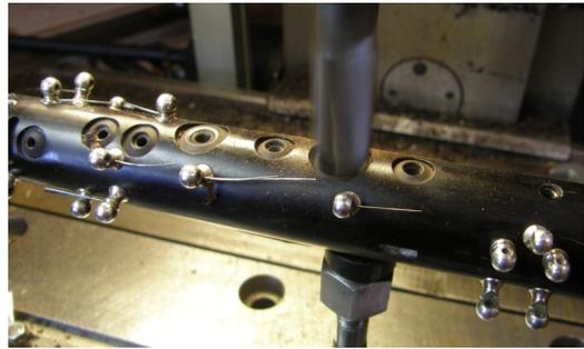
Neue Nockenbohrung setzen
