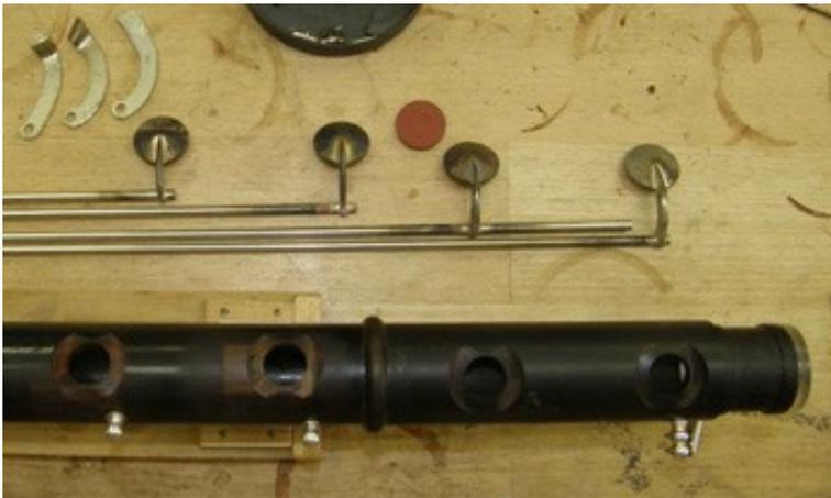
Nun wurden die alten Tonlöcher (E und Es) sowie die Säulchenbohrungen verschlossen. Anschließend das - entsprechend der korrekten Intonation des tiefen C lange - Anschlussstück aus Grenadill gefertigt und angesetzt und die 4 neuen Löcher an die jeweils akustisch richtige Stelle gebohrt. Die Doppelsäulchen haben wir aus Vollsilber gefertigt und den Drückern eine neuartige Form gegeben.
