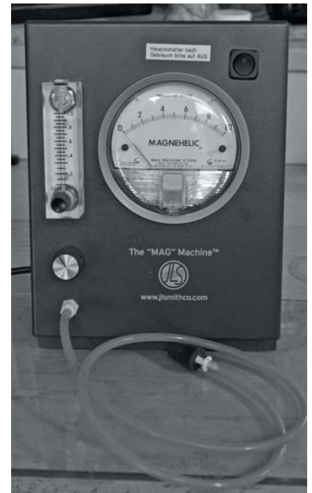
Abb. 1: Messinstrument für die Dichtheit von Holzblasinstrumenten.
