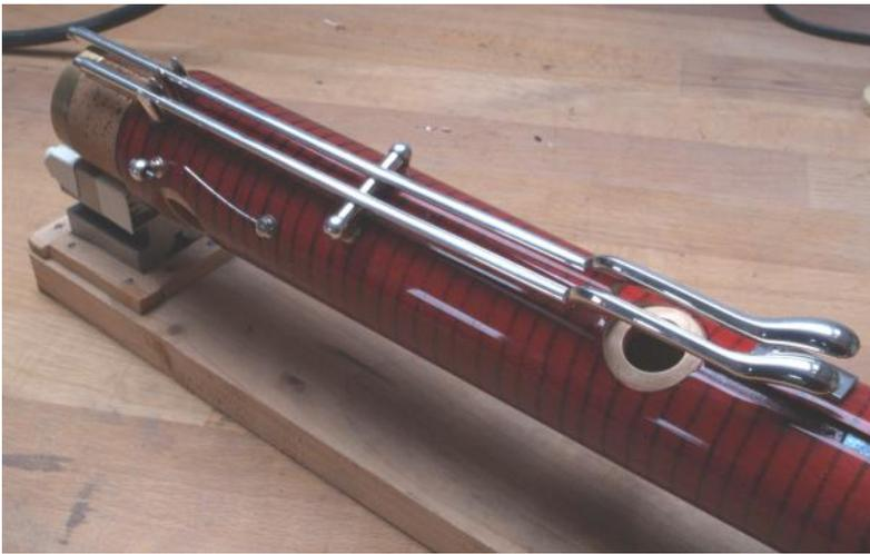
**1c** Kontra-B-Drücker (rechts), schließt über Kontra-B-Verbindung (1b) die Kontra-B-Klappe (1a) an der Haube
